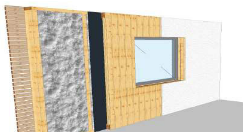
Pojedinačni slojevi zida i razrada otvora.
