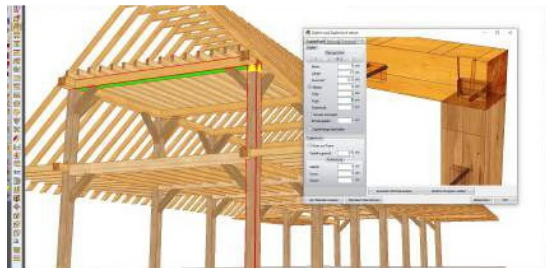
Definiranje tesarskog spoja na modelu konstrukcije.
